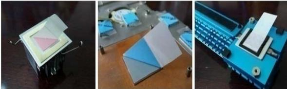
TIC™800G系列 是一種高性能低熔點相變化導熱界面材料。在溫度50℃，TIC™800G開始軟化並流動，填充散熱片和積體電路板的接觸介面上細微不規則間隙，以達到減小熱阻的目的。TIC™800G系列在室溫下呈可彎曲固態，無需增強材料而獨立使用，免除了增強材料對熱傳導性能的影響。而在工作溫度下，其中相變材料軟化的同時又不會完全液化或溢出。
