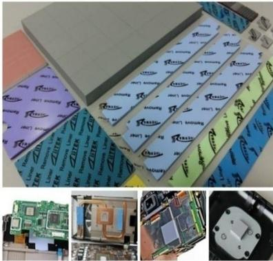
TIF700Q是一种填充发热器件和散热片或金属底座二者之间的空气间隙。它们的柔性、弹性特征使其能够用于覆盖非常不平整的表面。其优异的效能使热量从发热器件或整个PCB传导到金属外壳或扩散板上，从而提高发热电子组件的效率和使用寿命。
