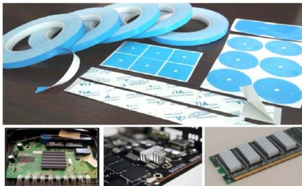
TIA™ 600P系列产品大量应用于粘接散热片到微处理器和其它的功率消耗半导体上，这些胶带具有极强的粘合强度，并且热阻抗小，可以有效的取代滑脂和机械固定。
